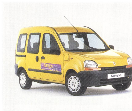
Renault Kangoo électrique: Nutzlasten bis 493 kg.
