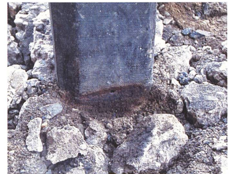
Bild 2 Freigelegter Korrosionsangriff im Erdeintrittsbereich.
