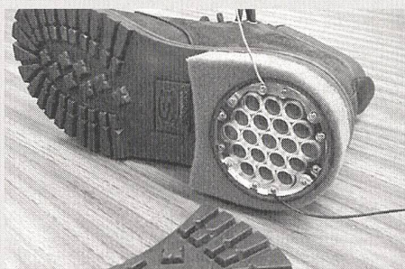
Prototypschuh mit Sohle aus speziellem elastischen Material.
