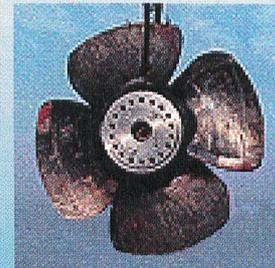
querschnitt. Man war zunächst ratlos. Diese Erscheinungen, die auch den Wirkungsgrad der Turbine stark reduzierten, waren bei bisher bekannten Laufrädern noch nie aufgetreten. Nach langen, nervtötenden Versuchen konnten die Schwierigkeiten gemeistert werden: Verbesserungen an den Schaufeln des Laufrades und eine bessere Strömungsführung waren die Lösung.
