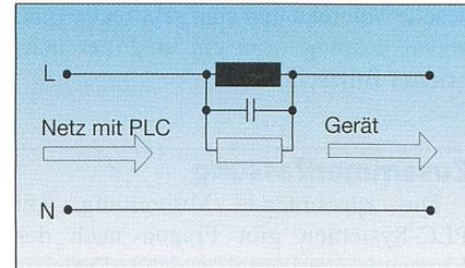
Bild 5 Low-Impedance-Filter
