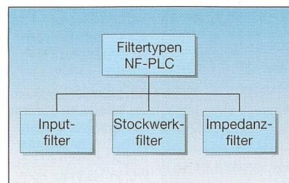
Bild 2 NF-PLC-Filtertypen
