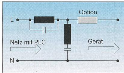
Bild 6 Low-Impedance-High-Noise-Filter
