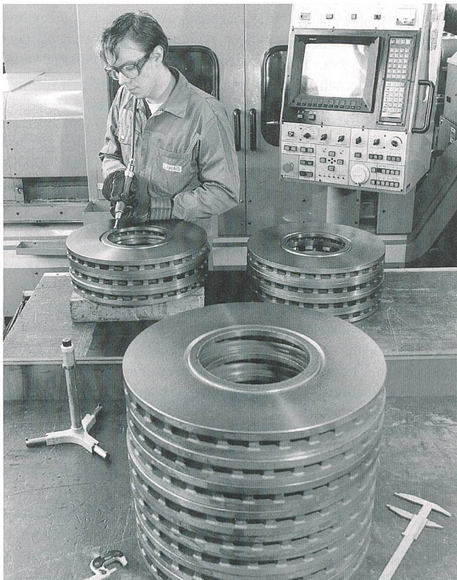
Strom für die Industrie: Fabrikation von Bremsscheiben (DaimlerChrysler).
