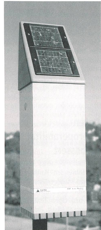
Permanente Überwachung mit dem Narda Area Monitor System 2600. Gut sichtbar sind die Solarzellen für die unabhängige Stromversorgung
