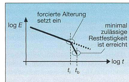
Bild 2 Forcierte Alterung ab dem Zeitpunkt  $t_i$
