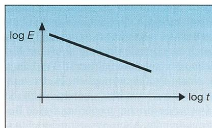
Bild 1 Festigkeit der Isolation in Abhängigkeit des Alters
