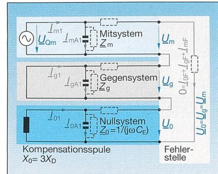
Bild 2 Vereinfachte Transformation eines Erdschlusses im Komponentensystem
