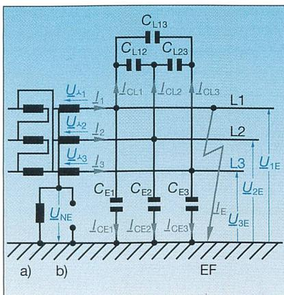
Bild 1 Ersatzschaltung eines Übertragungsnetzes ohne Berücksichtigung von Längsimpedanzen
