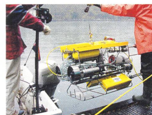
Zum Einsatz kamen modernste Hilfsmittel wie der Tauchroboter mit Videokamera (Bilder Rheinaubund).
