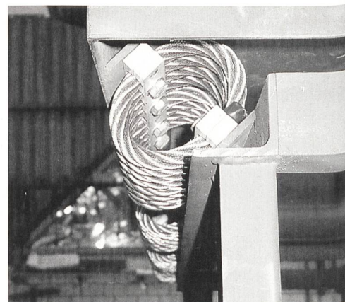
Bild 5 Bodenrahmen mit Drahtseilfeder-Elementen.
