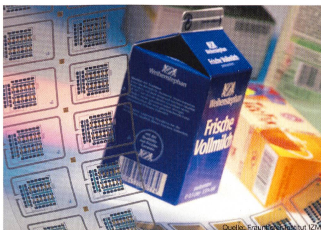
Bild 1 RFID-Labels ersetzen den Strichcode
