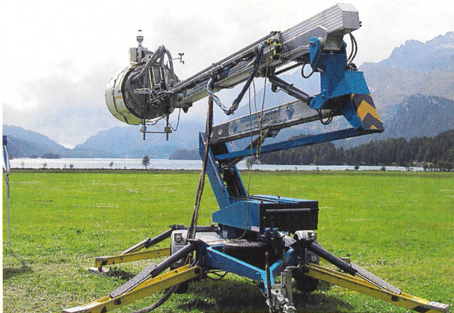
Keine Windenergie-Messstation, sondern eine Installation, um Turbulenzen im Wind zu messen (Bild: Beat Lüthi).
