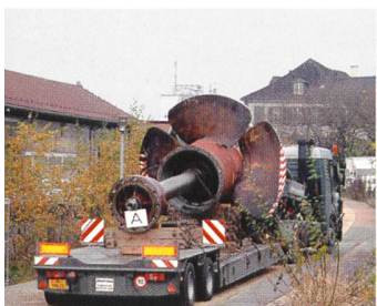
Neue Kaplan-turbine für das Wasserkraftwerk Letten in Zürich.
