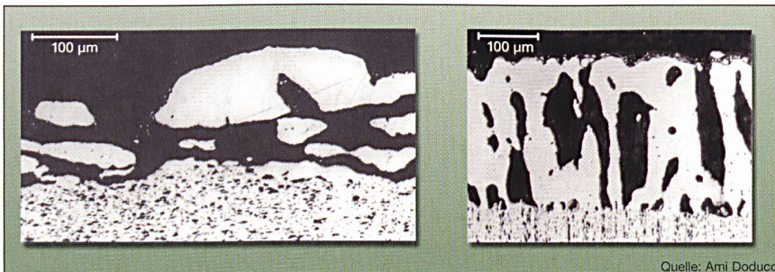
Bild 6 Schaltgefüge von Ag/C 3 3 ) nach Lichtbogeneinwirkung
