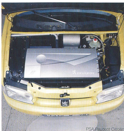
Compartment moteur et pile à combustible du Peugeot Partner Taxi Pile A Combustible
