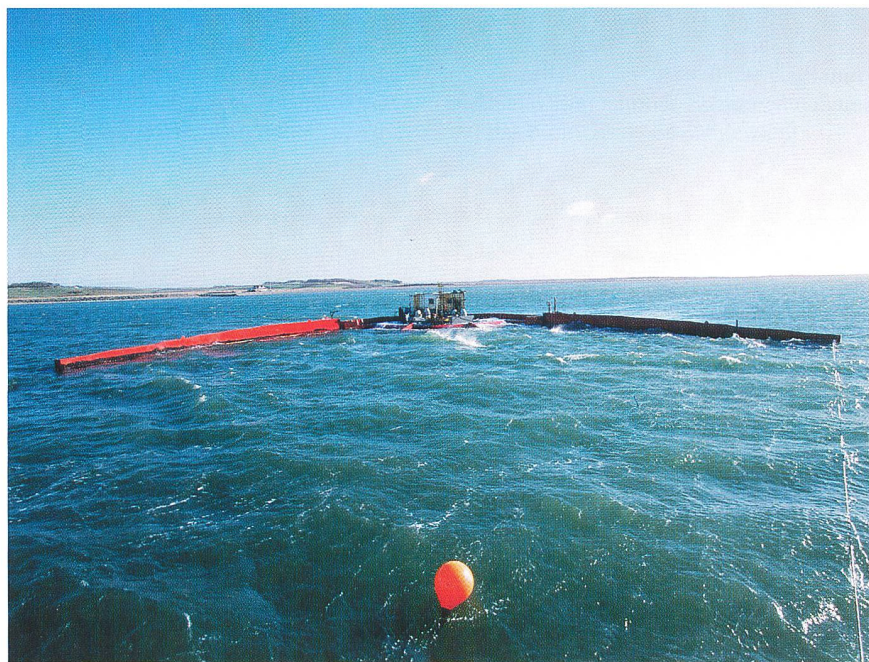
Der Test des 57 Meter langen und 261 Tonnen schweren «Wave Dragon» begann im März 2003 (Foto Wavedragon).
