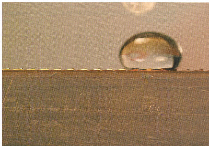
Ein Wassertropfen bewegt sich auf einer Messingplatte «entgegen» der Sägezahnrichtung (Bild: Michael Taormina, Benjamin Aleman)
