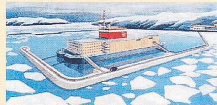
Das schwimmende Kernkraftwerk soll Strom erzeugen und Meerwasser entsalzen (Bild Sewmasch).
