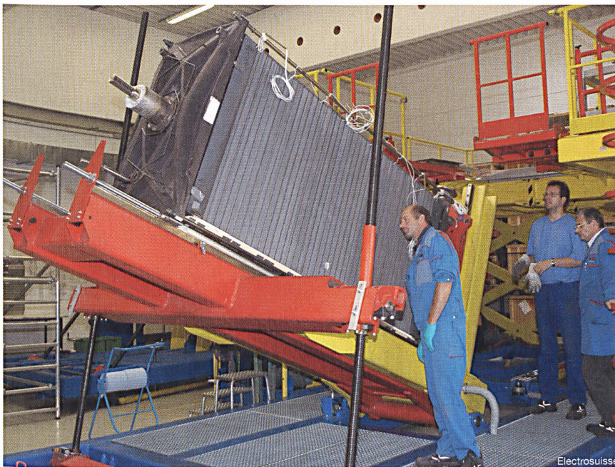
Bild 5 Fertigung des Brennstoffzellenstapels bei der MTU in München
