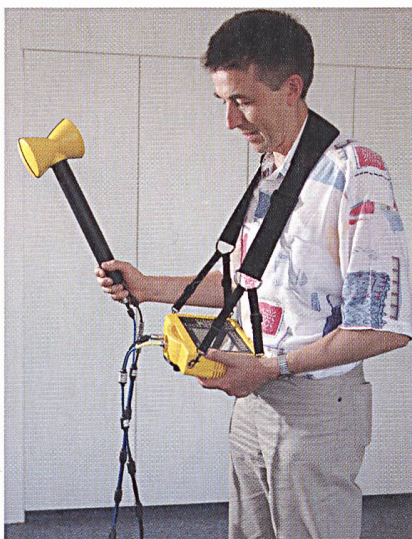
Das Feldstärkemessgerät SRM-3000 von Narda im Einsatz
