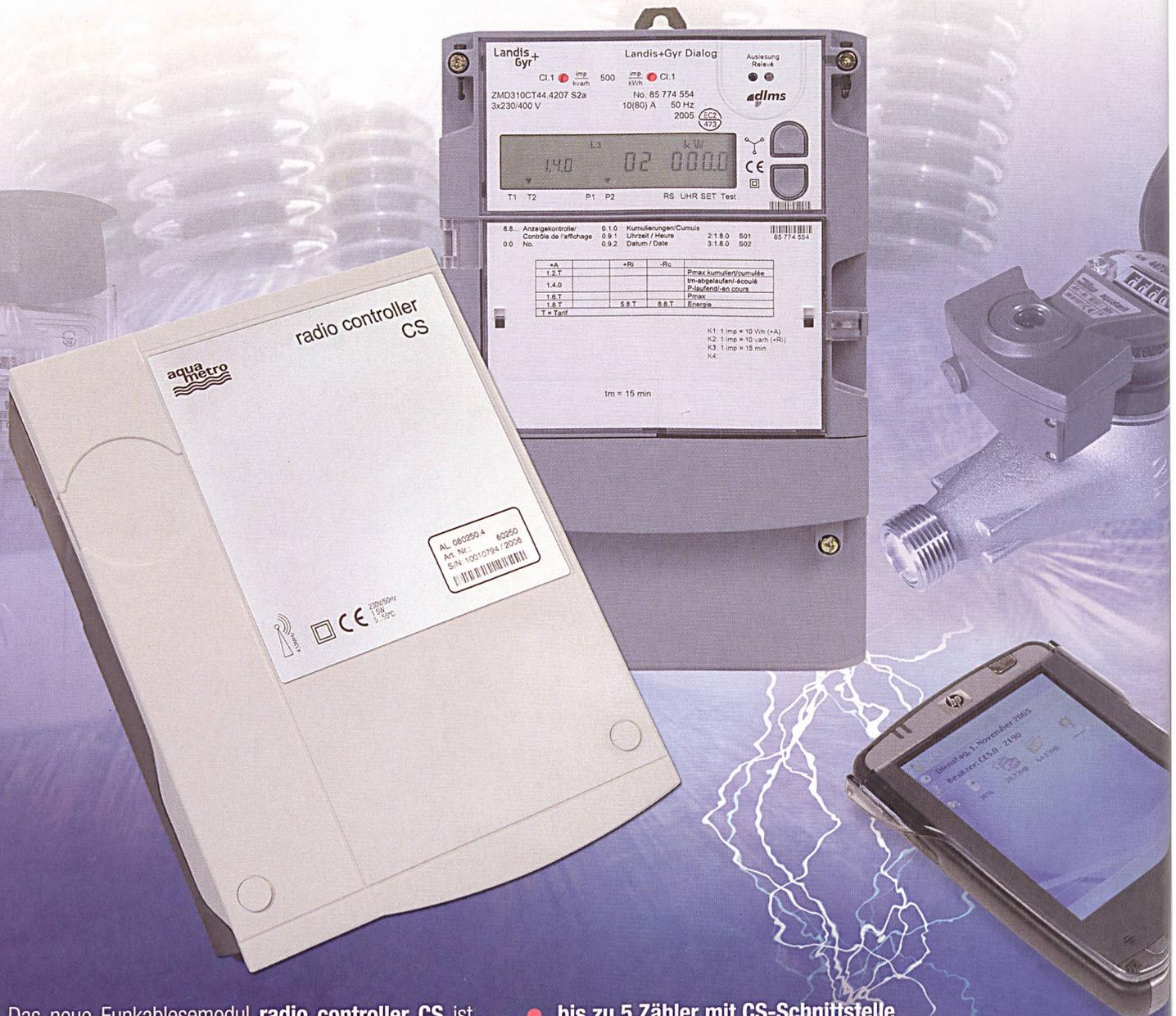
Das neue Funkablesemodul **radio controller CS** ist für bis zu 7 Zähler konzipiert. Der CS-Eingang erlaubt Ihnen bis 5 Zähler in Serie anzuschliessen. Für weitere 2 Zähler stehen Ihnen Impulseingänge zur Verfügung. Somit können Sie mehrere Stromzähler, oder in einem Einfamilienhaus die Strom-, Gas- und Wasserzähler über ein einziges Funkmodul auslesen und übertragen. Das Modul wurde in Zusammenarbeit mit ascom entwickelt und bietet zudem verschiedene Stichtags- und Loggerfunktionen.
