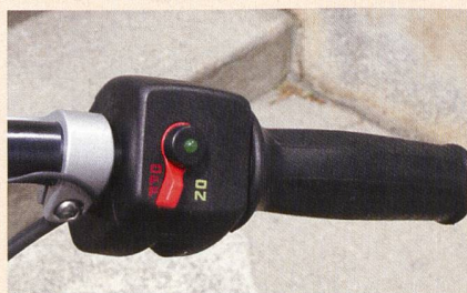
Detailansicht: Schalter für die Lichtanlage und rechts der Gasgriff, mit dem man mehr oder weniger Unterstützung des Motors anfordert. Falls das grüne Lämpchen einmal nicht brennt, liegt ein Erdschluss vor – Service wäre dann angezeigt.
