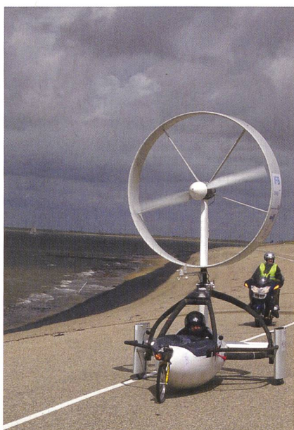
Das Ventomobil fährt direkt gegen den Wind.
