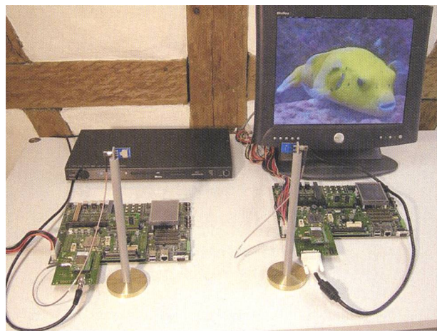
Bild 11 Prototyp für die UWB-Übertragung eines Videostroms.
