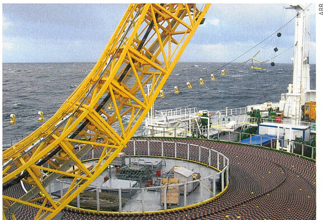
Die HGÜ-Kabel für den Stromtransport über das Meer werden mithilfe eines speziellen Verlegeschiffs auf dem Meeresboden platziert.
