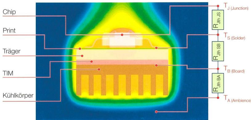
**Bild 3** Thermisches Ersatzschaltbild einer LED mit Kühlkörper.
