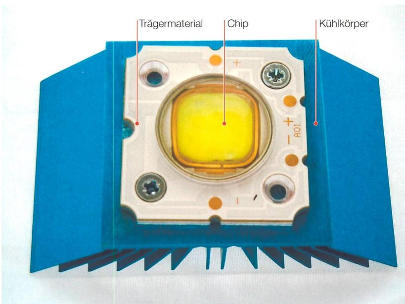
**Bild 1** 10-W-Power-LED montiert auf Lamellen-Kühlkörper mit 1,3 K/W.
