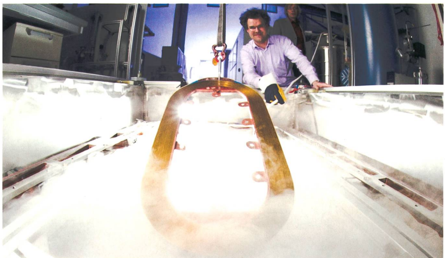
Prototyp: Spule für einen künftigen Generator in einem mit Flüssigstickstoff gefüllten Kühlbecken.
