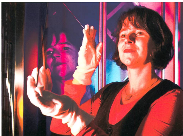
Eine Glasplatte mit einer transparenten, leitfähigen Titandioxid-Schicht.
