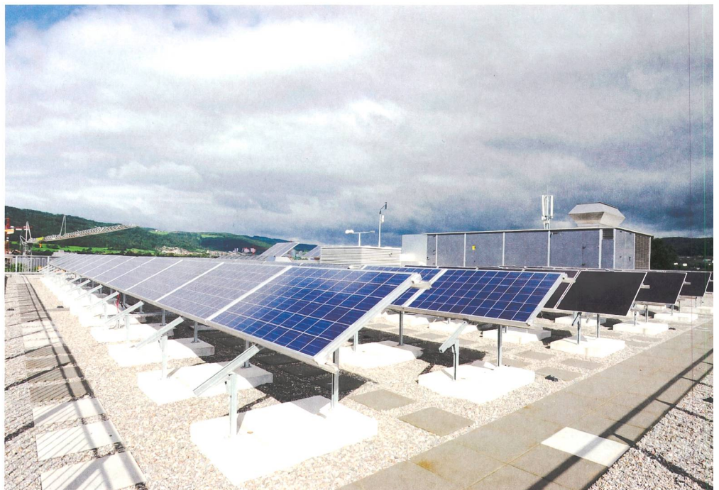
Bild 1 Fünf verschiedene Solarmodultechnologien werden in Dietikon getestet: polykristallines Silizium, Silizium-HIT, Dünnschicht uc-Si/a-Si, Dünnschicht-CIS und Dünnschicht-CdTe.
