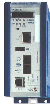
Die «Industrial Firewall» Eagle20 wird direkt an Maschinen und Anlagenteile eingesetzt.
