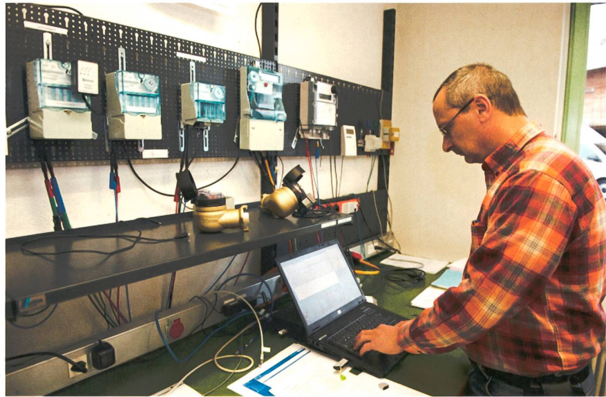
Ein Mitarbeiter der Arbon Energie AG prüft AMIS-Zähler mit Wasserzählern.
