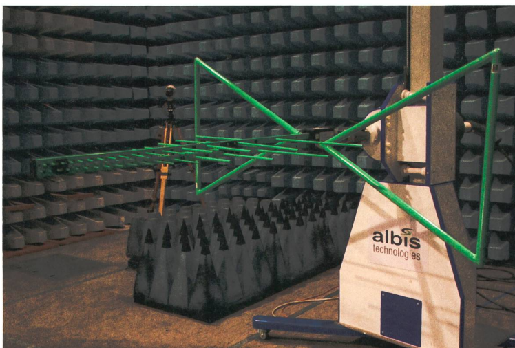
Die absorbierende Halle ermöglicht die EMV-Prüfung von Kommunikationsgeräten und kann z.B. zur Störausstrahlungsmessung bei Netzgeräten verwendet werden.
