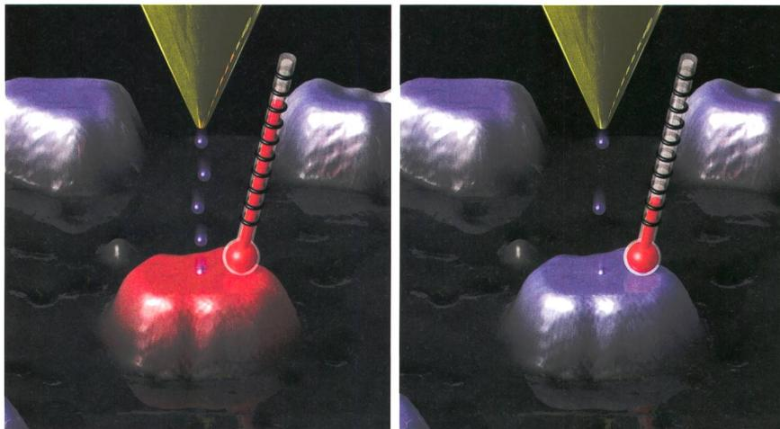
Principe du réchauffement d'un nanoaimant par un courant tunnel : des électrons (en bleu) sont émis par la pointe d'un microscope à effet tunnel (en jaune) avant d'atteindre le nanoaimant. La fréquence de la commutation magnétique permet alors de déterminer la température, symbolisée ici par un thermomètre. Lorsque le courant est faible, le nanoaimant présente la température de son environnement (à droite). Dès que le courant est augmenté, les électrons réchauffent le nanoaimant (à gauche).
