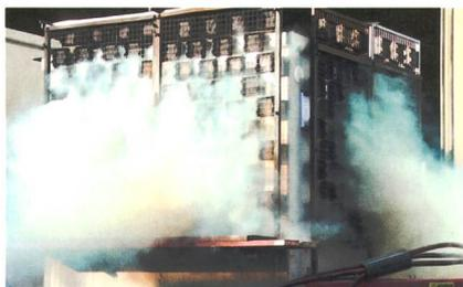
Je nach Mittelspannungs-Schaltanlagentyp und Druckentlastungssystem entstehen im Druckentlastungsraum Belastungen bis nahezu 400 mbar.
