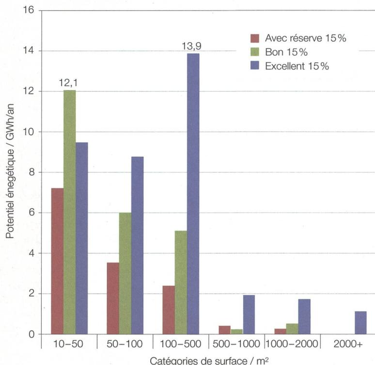
Figure 2 Potentiel énergétique en ville de Neuchâtel en fonction des surfaces de toit.
