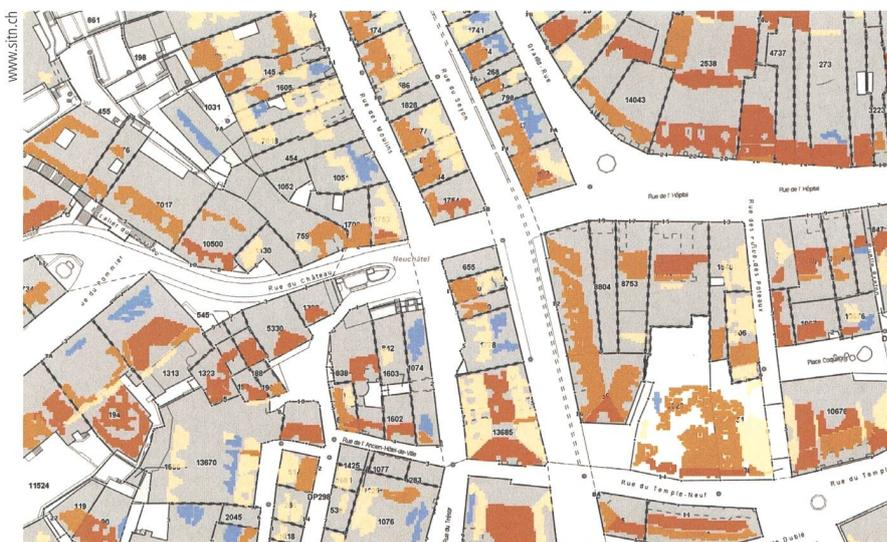
Figure 1 Résultats de l'analyse « capteurs photovoltaïques par face de toit ».
