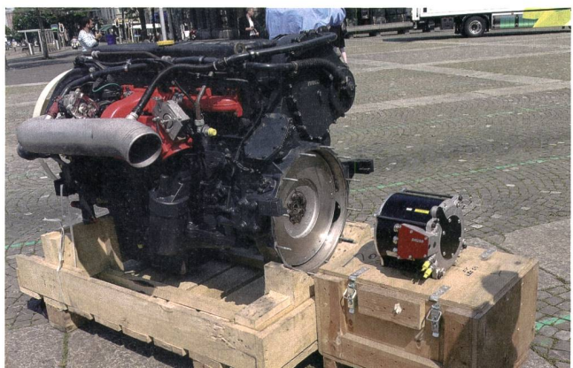
Der Grössenunterschied ist frappant: Diesel- und Elektromotor mit gleicher Leistung.
