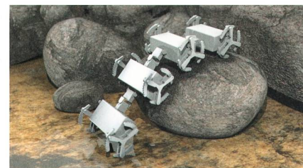
Der Centipede ist flach und kann durch Spalten kriechen, die für Menschen zu eng sind.
