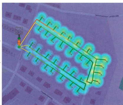
Die Software zeigt Netzbetreibern an, wie viel Ladelast ihr Niederspannungsnetz verträgt.
