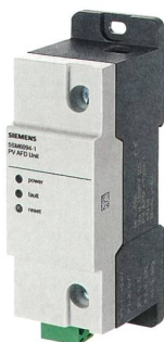
Der Brandschutzschalter misst das Hochfrequenzrauschen von Spannung und Strom.
