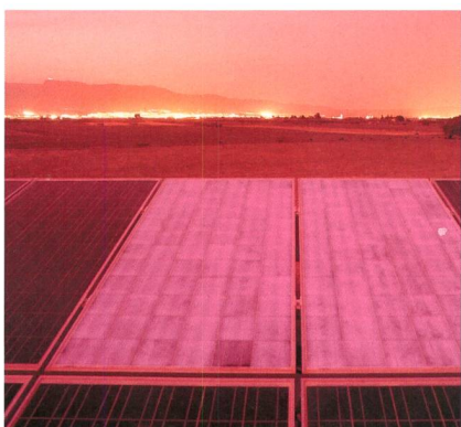
Module werden nachts für den Elektrolumineszenz-Test bestromt.
