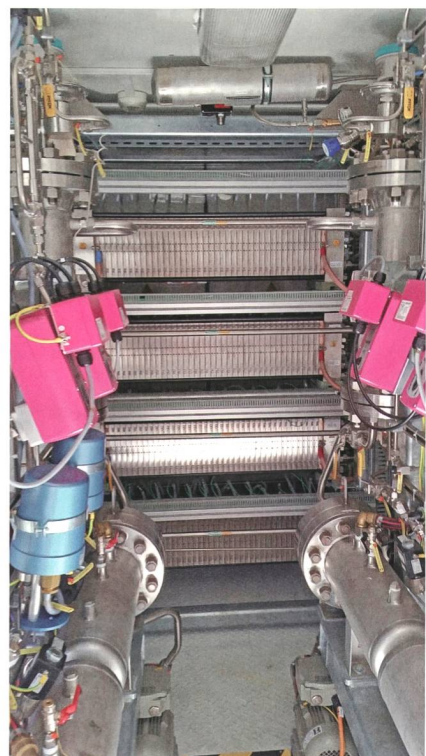
Bild 3 Im Hintergrund die PE-Stacks des Elektrolyseurs, vorne die Gas- und Wasseraufbereitung.
