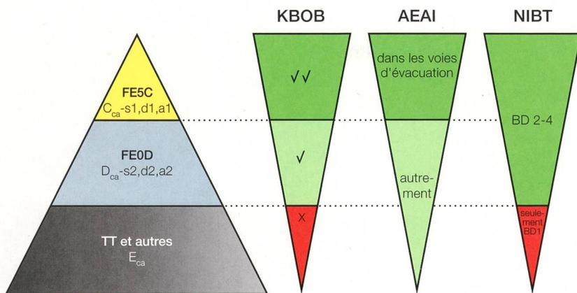
**Figure 2** Les câbles pour les différents niveaux de protection incendie exigés en Suisse et leur aptitude selon les différents règlements.
