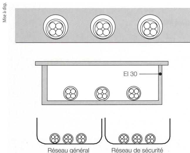
**Figure 6** Image à droite du paragraphe 3.4.4 de [10]. Une alimentation en électricité est soit à séparer par des mesures architecturales (comme en haut ou au milieu), soit à installer avec maintien de la fonction séparément du réseau (en bas). Le dessin suggère maintenant aussi une pose séparée (ce n'était pas encore le cas dans l'ancienne version de [10]).
