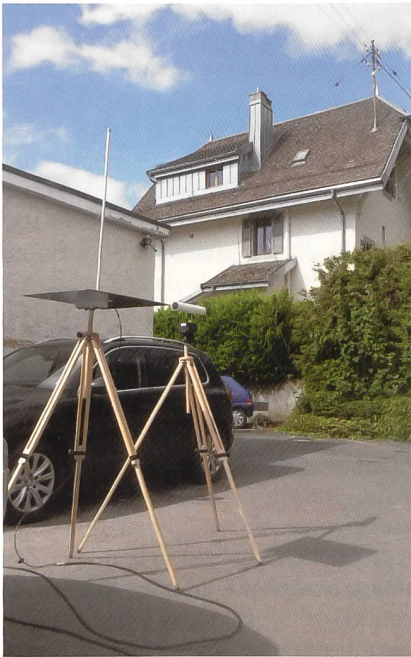
Figure 4 Antennes pour les mesures des perturbations électromagnétiques.
