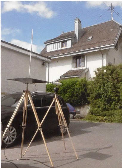
Bild 4 Antennen zur Messung von elektromagnetischen Störungen.
