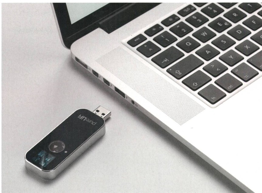
Les signaux modulés par les drivers Li-Fi spéciaux intégrés aux luminaires sont détectés par des capteurs ou photodétecteurs branchés ou intégrés aux ordinateurs, smartphones, tablettes ou autres appareils.
