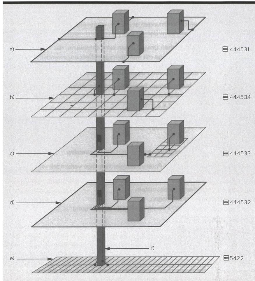
**Bild 5** Beispiele von Potenzialausgleichsanlagen in einem Gebäude mit mehreren Stockwerken ohne Blitzschutzanlage (4.4.4 Figur 20), **a)** Potenzialausgleichsnetzwerk durch geschlossene Leiterschleife (BRC), **b)** Vermaschtes sternförmiges Verbindungsnetzwerk **c)** Mehrfachverbindung vermaschtes, sternförmiges Netzwerk, **d)** Sternförmiges Netzwerk der Schutzleiter, **e)** Fundamenteerder, **f)** Metallene Gebäudekonstruktion.
