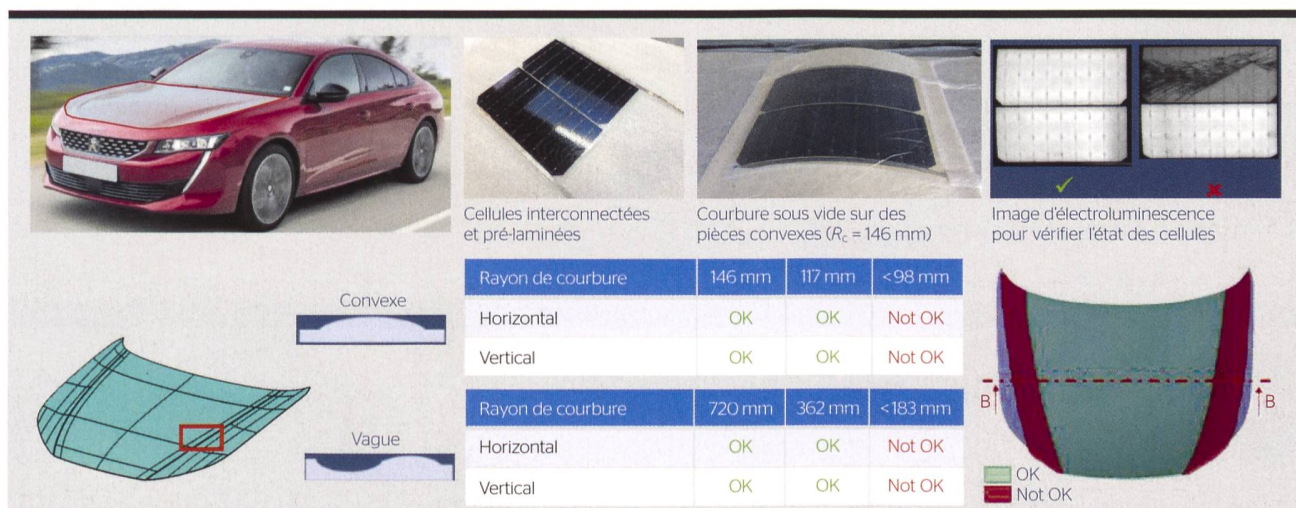
Figure 3 Méthode d'évaluation rapide pour déterminer le rayon de courbure minimal des cellules en silicium interconnectées ainsi que les zones pour lesquelles l'intégration de cellules PV dans la carrosserie est possible.
