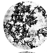
Vielleicht noch schädlicher sind diese spitzen Kristalle, die — wie Nadeln — die feinen Faserwände anstechen und aufkratzen. Aufnahme durch das Mikroskop in ebenfalls 200facher Vergrösserung.
