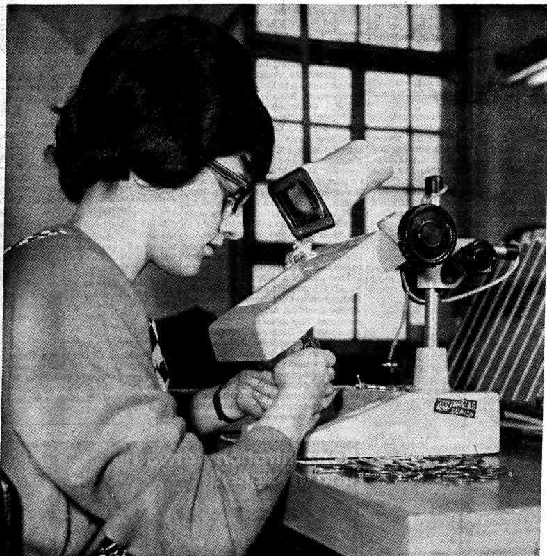
Kontrollleurin von Kleinteilen: Manchmal sind 30 und auch mehr Merkmale bei den Kontrollen zu beachten, und oft wird nach Plänen und Zeichnungen kontrolliert. Am Ende hängt das gute Funktionieren grosser Maschinen auch mit von der genauen Arbeit der Kontrollleurin ab.
