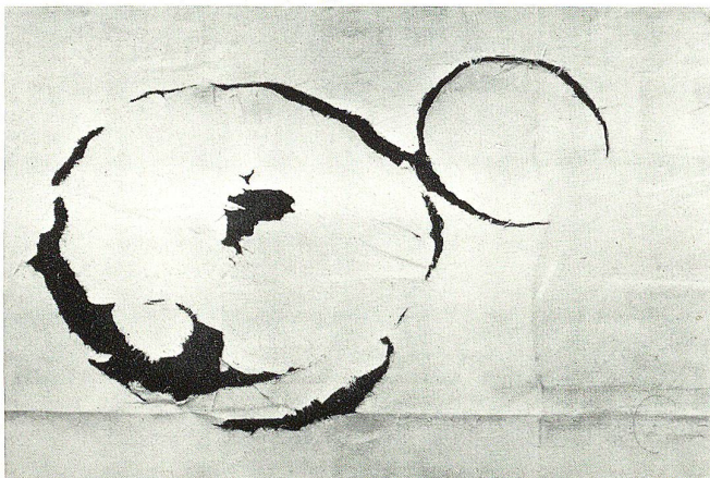
Durch Putzpulver, vielleicht auch durch Ausleeren von Wein hat sich aus Metalluntersätzen Kupfer oder Nickel gelöst und die kreisförmige Verbrennung auf dem Tischtuch bei der Wäsche und Behandlung mit Bleichmitteln bewirkt
